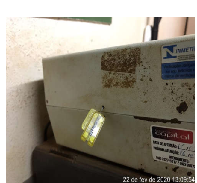
39 | Selo de calibração Inmetro da Balança de pesagem
