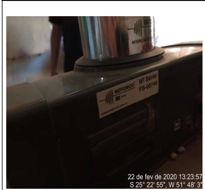
39 | Selo de calibração Inmetro da Balança de pesagem
